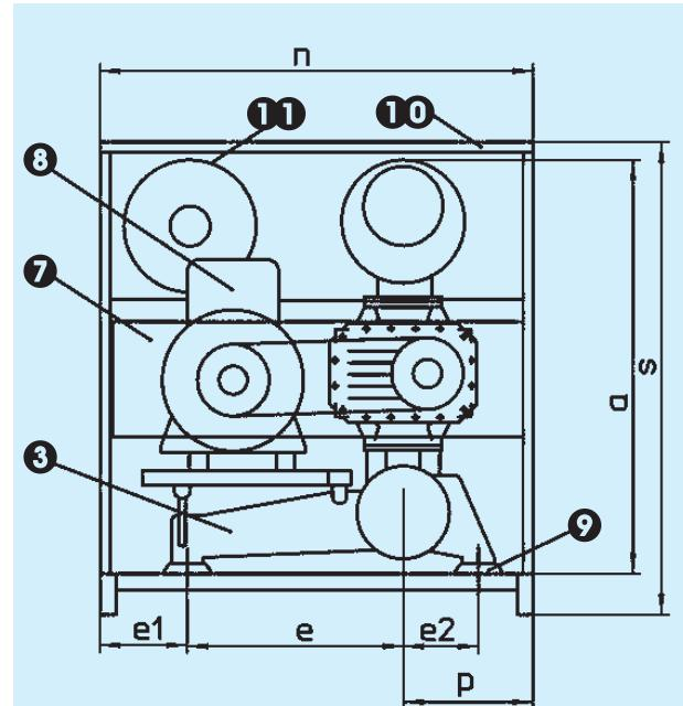
⑦ Protección transmisión - *Protection guard* ⑧ Motor eléctrico - *Electrical motor* ⑨ Pies elásticos - *Elastic feet* - ⑩ Cabina insonorización - *Acoustic hood* ⑪ Ventilador eléctrico - *Electrical fan* ⑫ Tubo brida - *Connecting pipe with flange*.
