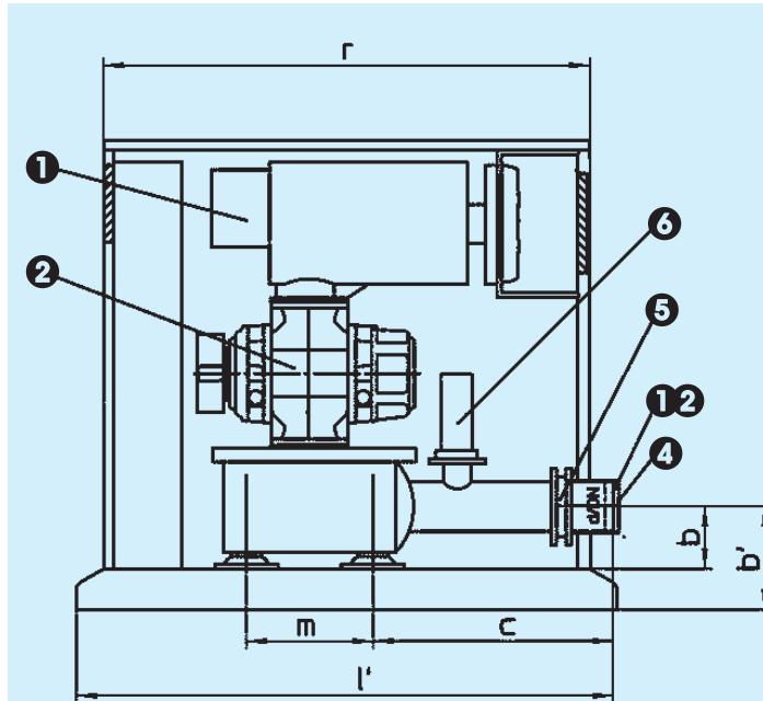
① Filtro aspiración - *inlet Filter* ② Soplante - *Blower* ③ Silenciador bancada - *Frame Silencer* - ④ Manguito - *Rubber sleeve* ⑤ Válvula de retención - *Check valve* ⑥ Válvula de Seguridad - *Relief Valve*
